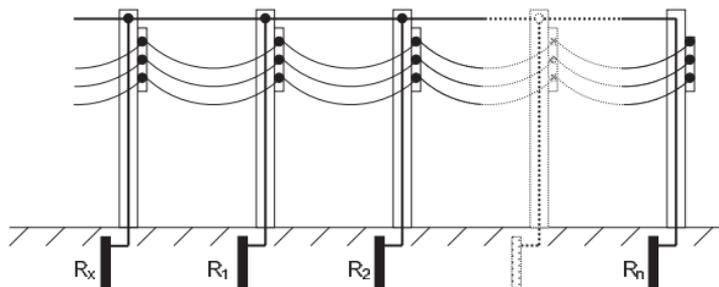
この接地抵抗のうち、 $R_1$ 、 $R_2$ 、 $\dots$ 、 $R_n$ は全て並列接続されているものとして考えられ、一つの合成抵抗とみなすことができます。この $R_1$ 、 $R_2$ 、 $\dots$ 、 $R_n$ の合成抵抗を $R_s$ とします。 $R_s$ は複数の抵抗が並列に接続された合成抵抗なので $R_x$ に対して十分に小さいとみなすことができます。
