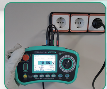
Kiểm thử mạch vòng từ ổ cắm tường
