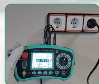
Tes loop dari stopkontak dinding
