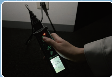
ไฟแบ็คไลท์ LCD จะติดขึ้นโดยอัตโนมัติเมื่ออยู่ในที่มืด
