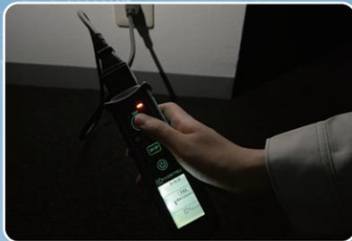
Le rétroéclairage de l'écran LCD s'allume automatiquement dans des zones sombres.
