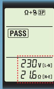
La tension L-N et la résistance N-E au système TT peuvent être affichées.
