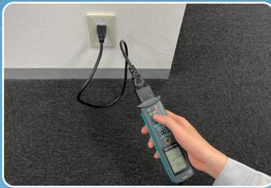
Mesure facile en se branchant simplement sur une prise et en appuyant sur le bouton test.
