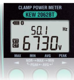
En définissant le CT et le VT le rapport et la mesure du côté secondaire du transformateur, la valeur du côté primaire peut être obtenue.
