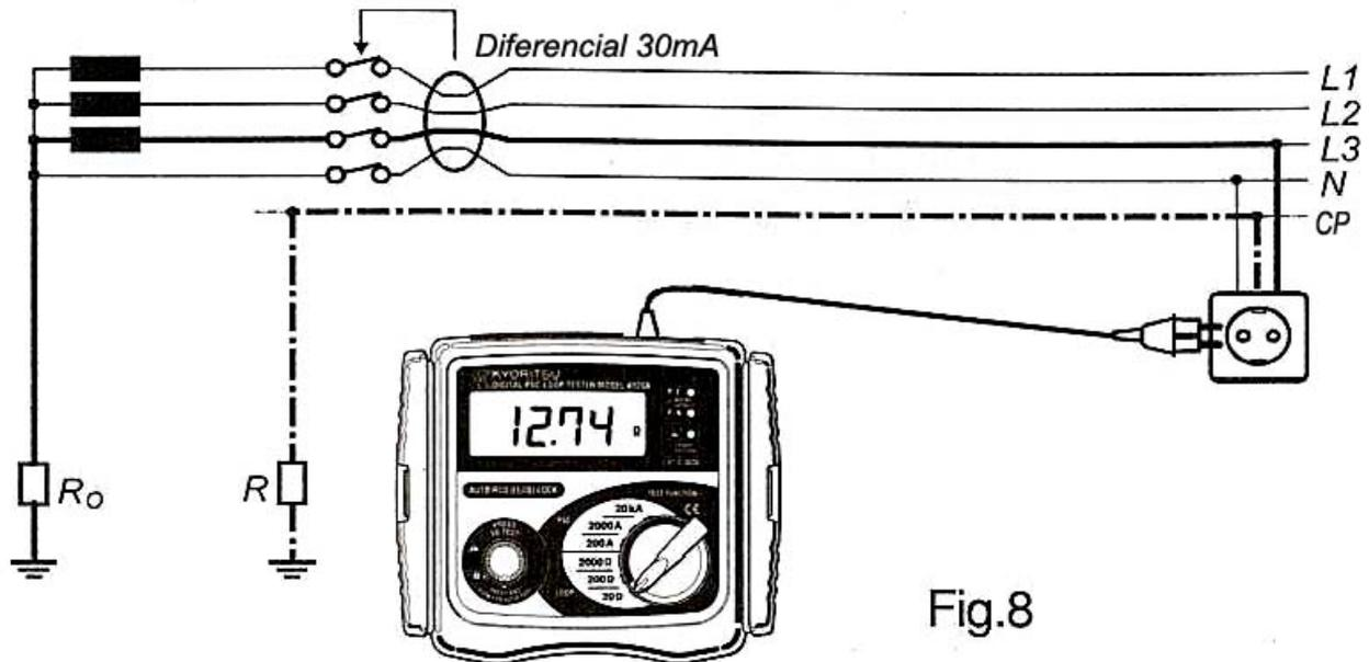
Para este ejemplo el valor máximo es de  $1667\Omega$ , el medidor de bucle indica  $12,74\Omega$ , lo que significa que se respeta la condición  $RA \leq 50/la$ .
