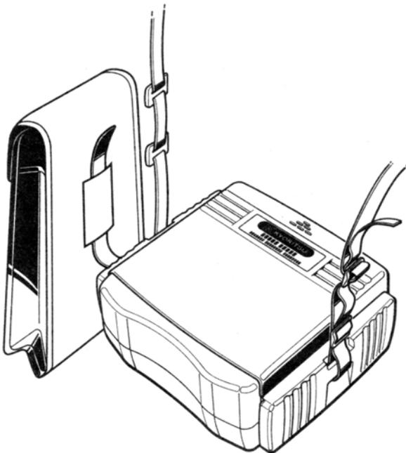
Pase la correa hacia abajo a través de las ranuras situadas en los laterales del instrumento, pase la correa a través de las ranuras situadas en la parte posterior de la bolsa de los cables de prueba.
