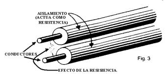
c) Fuga de corriente: Esta corriente fluye entre los conductores; esta diferencia de potencial a lo largo de la superficie del aislamiento es ocasionada por suciedad y/o humedad.
