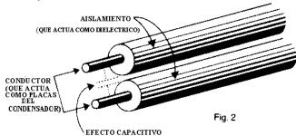
b) Corriente de conducción: Esta corriente fluye a través del aislamiento entre sí mismo porque la resistencia del aislamiento no es infinita. La ley de Ohm's se aplican.
