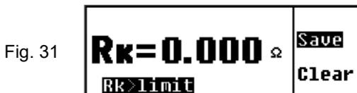
Nota) El siguiente mensaje indica que no se pueden guardar los datos si seleccionamos márgenes de medición de  $R_k$  200k $\Omega$  o superiores. Los valores de  $R_k$  guardados en los márgenes de 2 $\Omega$  y 20 $\Omega$  se mantienen en los márgenes de 200k $\Omega$  y superiores.
