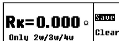
No se puede configurar Rk mientras se realiza una medición de resistividad de tierra. (Fig. 67)
