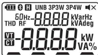
Al configurar el interruptor de función en cualquier posición que no sea "OFF", KEW 2060BT se inicia y todos los segmentos LCD se muestran durante 1 segundo. Confirme que no hay chips de segmentos.
