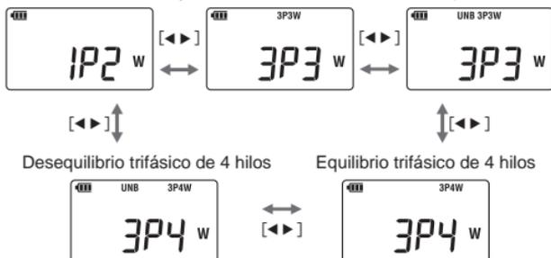
Presione el botón de modo mientras se muestra la configuración de cableado deseada. La selección es confirmado y la pantalla vuelve a la pantalla de selección.
