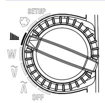
Atur tombol Fungsi ke " IIII ". Lauar LCD akan seperti gambar di sebelah kanan selama komunikasi Bluetooth: tidak ada nilai terukur yang ditampilkan. Nilai terukur dapat diperiksa dengan menggunakan aplikasi pada perangkat ponsel pintar atau tablet Anda, atau dengan memutus sambungan Bluetooth.
