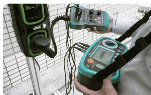
Ảnh kiểm thử điểm sạc EVSE bằng Bộ điều hợp EVSE và MFT
