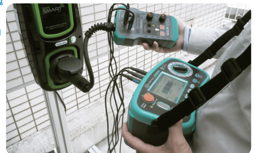
ภาพการทดสอบจุดชาร์จ EVSE โดยอะแดปเตอร์ EVSE และ MFT
