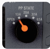
Resistencia entre PP y PE en función de la corriente nominal del cable
