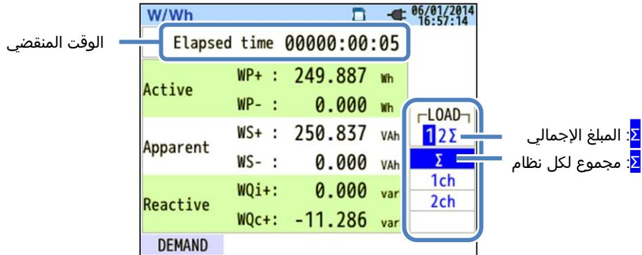
يتم عرض الطاقة المستخدمة في الفترة المحددة كاستهلاك الطاقة المتكامل. ويستخدم الاستهلاك المتكامل للطاقة لحساب تعريفات الكهرباء أو للسيطرة على استهلاك الطاقة.
