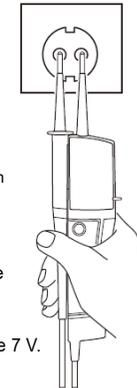
La LED du circuit sous tension s'allume et l'avertisseur sonore retentit lorsque la tension seuil de la LED de 50V est dépassée.
