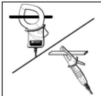
1. Accrochez l'objet mesuré et fixez le capteur. Fixez-le fermement pour qu'il ne se détache pas facilement.
