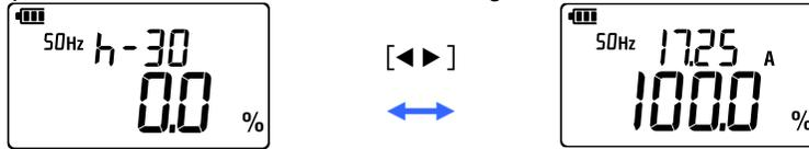
La zone supérieure montre l'commande des harmoniques (h-1 à h-30) et RMS de chaque harmonique: ces deux interrupteurs par seconde.
