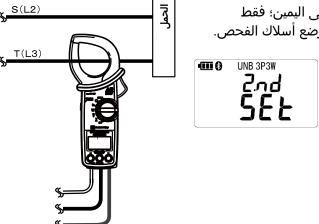
اضغط على زر تبديل الصنف [◄] بعد إجراء الاتصال، تعرض شاشة LCD الطاقة النشطة للطور (T(L3). يؤدي الضغط على زر الوضع إلى تبديل المؤشرات بين الطاقة النشطة وقيم جهد/تيار RMS لطور (T(L3).
