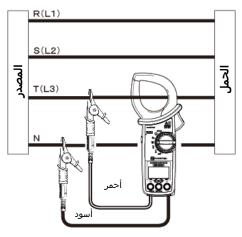
اضغط على زر تبديل الصنف [◄] بعد إجراء الاتصال، تعرض شاشة LCD الطاقة النشطة للطور (L3). يؤدي الضغط على زر الوضع إلى تحويل الإشارة إلى قيم جهد/تيار RMS للطور (T(L3).
