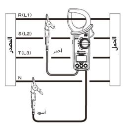
اضغط على زر تبديل الصنف [◄] بعد إجراء الاتصال، تعرض شاشة LCD الطاقة النشطة لطور (R(L1). يؤدي الضغط على زر الوضع إلى تبديل الإشارة بين الطاقة النشطة لطور (R(L1) وقيم الجهد/التيار RMS.
