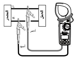
عندما تكون الوحدة المعروضة على شاشة LCD هي "A"، فهذا يعني أن الشاشة هي "شاشة قياس توافقيات التيار". اضغط باستمرار (الضغط لفترة طويلة) على زر تبديل a الصنف [⊀] لتحويل الوحدة إلى "V".
