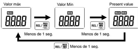
\* Para activar la función MAX/MIN, la función REL tiene que estar desactivada.
