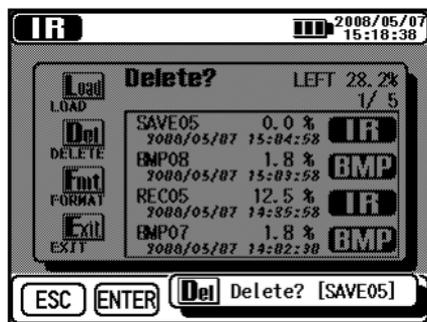
Aparece una pantalla de confirmación. Presione el Tecla ENTER para cargar el datos seleccionados.
