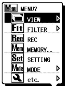
Mueva el cursor con los **Tecla UP/DOWN** o el **Selector Shuttle** y confirme la selección con el **Tecla ENTER**. Presionando el **Tecla ESC** mientras se muestra se cierra la Ventana de Menú.
