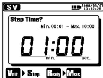
Los elementos de configuración para la medición de SV son los siguientes. Consulte la Configuración de Medición (=>P.38) y cambie los ajustes.
