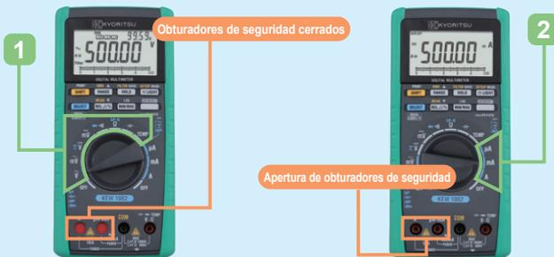
Si el DMM ("multímetro digital", según sus siglas en inglés) tiene el conmutador de funciones en la posición 1 (V, Ω, TEMP, etc.), los obturadores de seguridad cierran los terminales de entrada para las mediciones de corriente (µA, mA, A) y entonces no se pueden conectar los cables de prueba.
