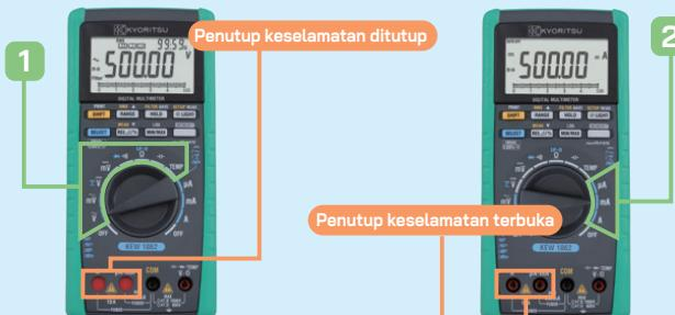
Jika DMM mempunyai sakelar fungsi pada posisi 1(V, Ω, TEMP, dll) penutup keselamatan menutup terminal masukan untuk pengukuran arus (µA, mA, A) dan kemudian uji timbal tidak dapat dipasang.
