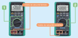
Si le DMM dispose du commutateur de fonction en position 1 (V,  $\Omega$ , TEMP, etc) les volets de sécurité ferment les bornes d'entrée pour les mesures de courant (µA, mA, A) et les fils d'essai ne peuvent être branchés.
