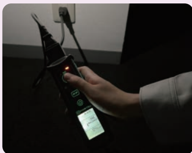
ไฟแบ็คไลท์ LCD จะติดขึ้นโดยอัตโนมัติเมื่ออยู่ในที่มืด *สามารถปิดไฟแบ็คไลท์ได้
