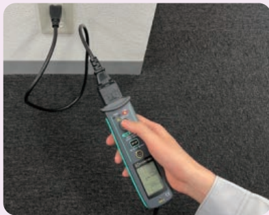
วัดง่ายเพียงเสียบเข้ากับช่องเสียบ และกดปุ่มทดสอบ
