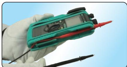
La sonda de prueba se puede fijar en el tapón
