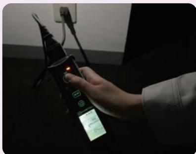
La retroiluminación LCD se enciende automáticamente en el lugar oscuro.
