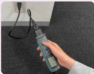
Facilidad de medición al conectar simplemente una salida de enchufe y pulsar el pulsador de prueba.
