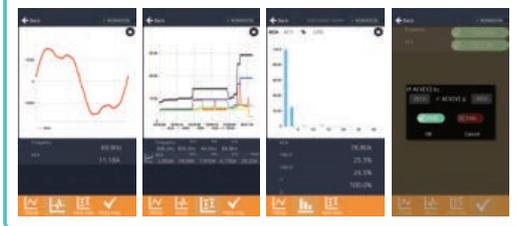
Descargue e instale nuestra aplicación especial "KEW Power" en su smartphone o tableta para registrar los valores medidos. El monitoreo remoto de tensión, corriente, potencia, gráfico de tendencias de armónicos y forma de onda es posible con "KEW Power"; esto es útil para una simple comprobación de la calidad de suministro. Los valores medidos se pueden guardar en su smartphone o tableta en formato csv: los datos se pueden editar en formato Excel.
