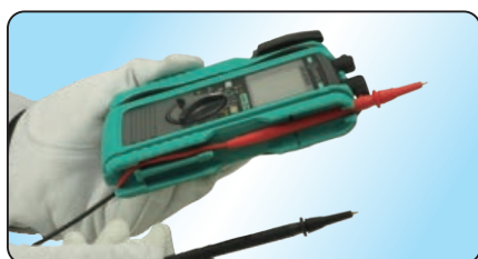
Perangkat pemeriksaan pengujian dapat dipasang ke wadah
