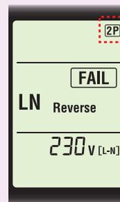
Le contrôle de câblage pour une prise 2P (sans terre) est également disponible en sélectionnant le réglage 2P.
