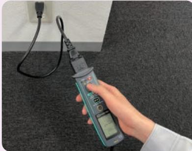
Mesure facile en branchant simplement dans une prise et en appuyant sur le bouton de test.
