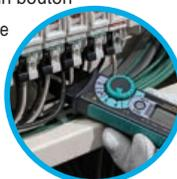
KEW 2300R peut être utilisé dans des boîtiers de connexion surchargés, où les câbles sont très courts, et où l'espace est trop limité pour fixer les câbles à l'aide d'un compteur de pince traditionnelle.
