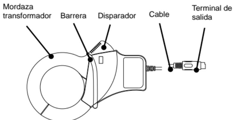
**Barrera:** proporciona protección contra descargas eléctricas y garantiza la distancia mínima necesaria de separación y las distancias de fuga. Siempre mantenga sus dedos detrás de la barrera durante una medición.
