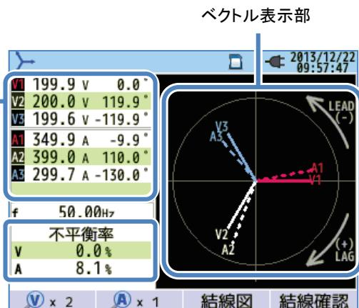
円の実線:電圧レンジ／電流レンジの最大値
