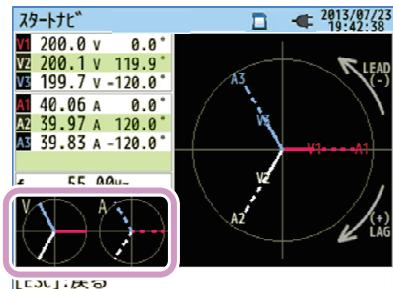
判定結果を閉じると、NG の値とベクトル線が点滅します。全て OK ならば参考として結線設定に準じた理想的なベクトル図のみを画面左下へ表示します。
