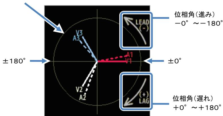
電圧レンジと電流レンジの最大値を円の実線で表示して電圧実効値と電流実効値を線の長さ、それぞれの位相関係をV1を基準(0°)にした線の角度にて表示します。3P3W3A／3P4Wの結線では同時に不平衡率を表示します。測定電圧と測定電流との関係が平衡な状態では下記のようなベクトル図を表示します。
