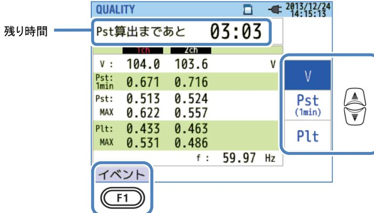
アーク炉負荷のような変動負荷がある場合に、電圧が変動して照明などがちらつく場合があります。このような状態を電圧フリッカといい、Pst、Pltでその厳しさを示します。
