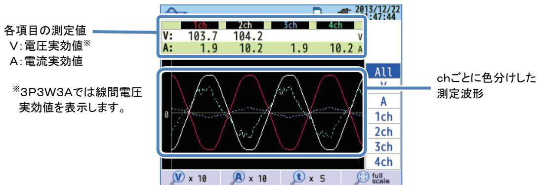
電圧の波形と電流の波形を50Hzならば最長10周期分、60Hzならば最長12周期分表示します。「波形」画面に切り替えると波形振幅と期間を最大で表示できる倍率を自動で選択して表示します。
