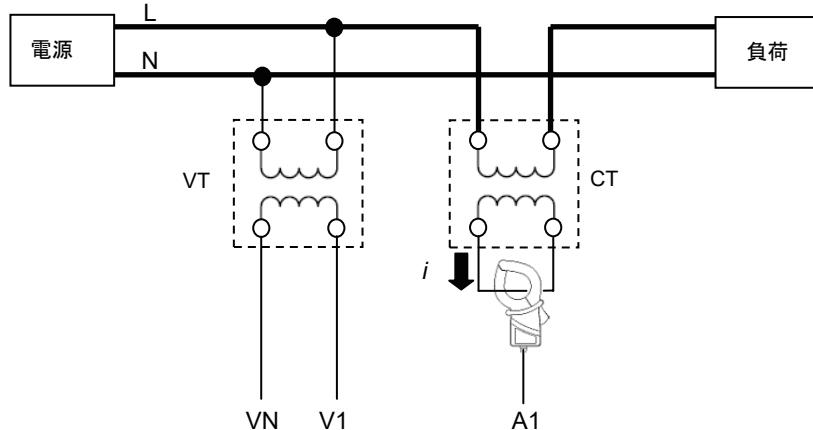
CTの2次側が5A定格の場合、クランプセンサは8128/8135(50Aタイプ)を使用し5Aレンジで使用することをおすすめします。
