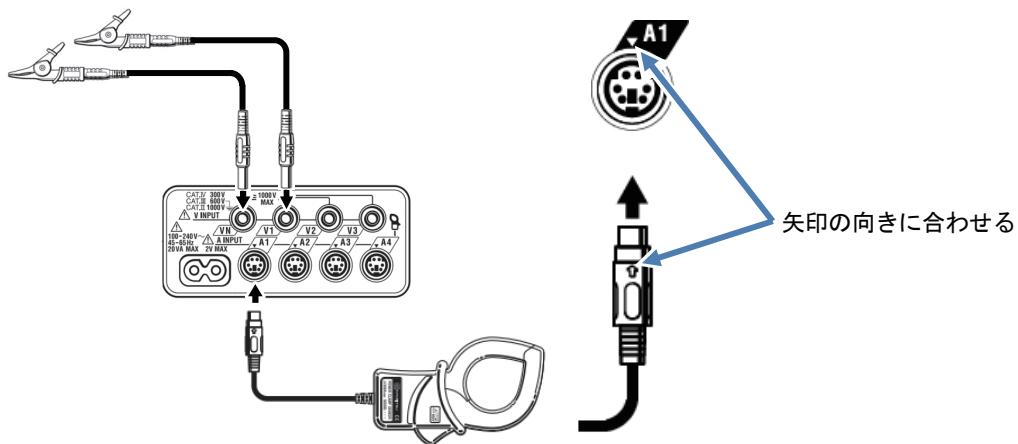
電圧用測定コードおよびクランプセンサの使用数、接続場所は結線方式によって異なります。「結線図」50頁を参照してください。
