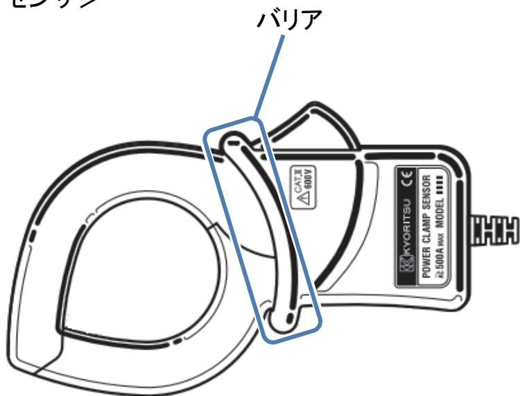
保護用フィンガガード及びバリアは操作中の感電事故を防ぐため、最低限必要な沿面および空間距離を確保するための目印です。
