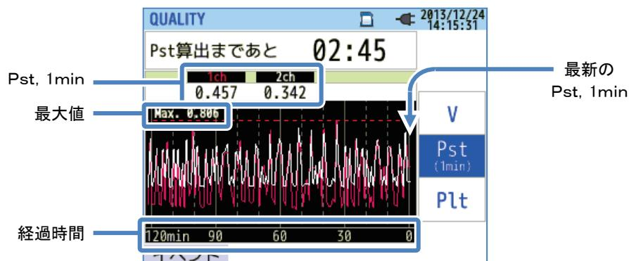
最新120分間に測定したPst, 1minのトレンドグラフを表示します。
