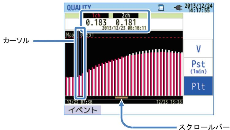
を操作することでカーソルの移動と、P lt の推移図を左右にスクロールさせます。スクロールバーには測定期間全体の範囲を黒色で表示し、現在の表示範囲を濃いオレンジ色で表示します。
