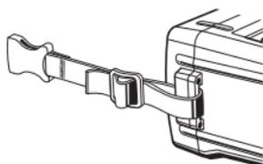
(3) 図 16-3 のように、肩掛ベルトの両サイドをサイドベルトへ取り付けます。
