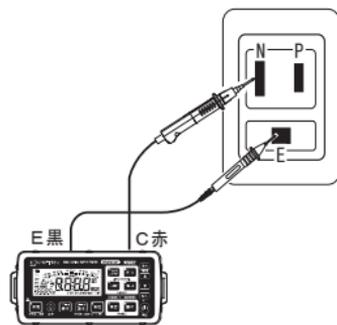
電源コンセントを用いた配線例
