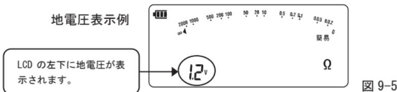
この電圧が10V未満であることを確認してください。10V以上の場合は、下図の地電圧警告のLEDが点灯します。(地電圧が400Hzの場合は5V以上でLEDが点灯)
