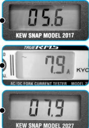
上記はサイリスタ制御のモータ負荷を測定したものです。真の実効値タイプの測定器は7.9 Aを指示するのに対して、平均値タイプは5.6 Aを指示します。
