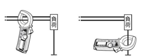
図1. 負荷電流測定
