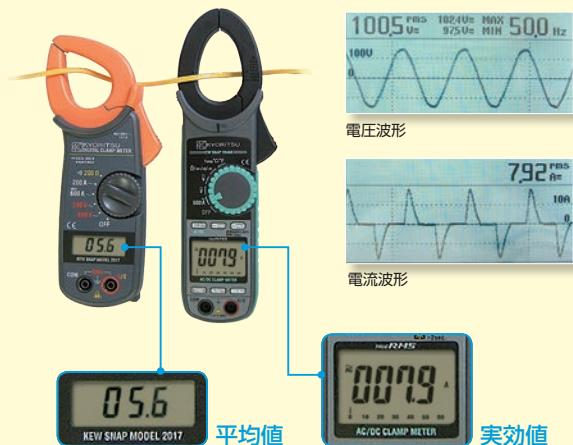
近年の電路は、サイリスタおよびインバータ制御等の省エネルギー設備により、商用周波数:正弦波(50/60Hz)に比べ、その電流波形は高調波成分を含み歪んでいます。
