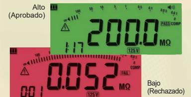
Fácil de identificar la resistencia baja o alta por el color de la retroiluminación LCD. Posible establecer diferentes valores de referencia para cada resistencia al aislamiento, respectivamente. (3552 / 3552BT)
