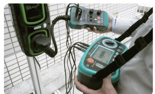
Foto pengujian titik pengisian EVSE oleh ADAPTOR EVSE dan MFT
