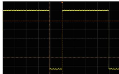
Forme d'onde du signal CP mesurée par oscilloscope
