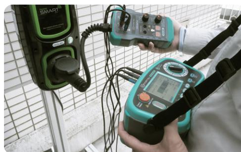
Photo d'essai de point de charge EVSE par ADAPTATEUR EVSE et TMF
