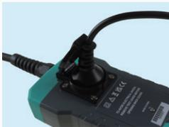
أثناء حالة CP يتم اختيار "C"، توفر EVSE الجهد الكهربائي على خرجها. يمكن توصيل الحمل الخارجي حتى 10A بالمقبس الموجود على الجانب الخلفي لـ KEW 8602 للتحقق من التشغيل بسهولة.
