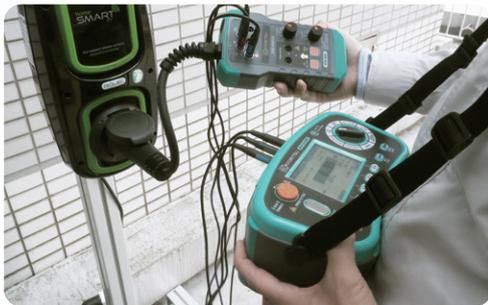
صورة لاختبار نقطة شحن EVSE بواسطة محول EVSE وMFT
