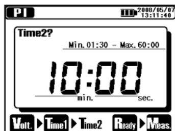
Instrumen memasuki Mode Siaga saat pengaturan dibuat. Item pengaturan untuk pengukuran PI adalah sebagai berikut. Lihat **Pengaturan Pengukuran (=>Hlm. 35)** dan ubah pengaturan.
