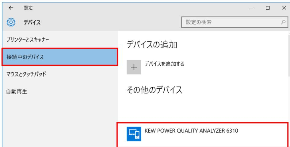
下図のようにデバイス名「KEW POWER QUALITY ANALYZER 6310」の下にメッセージが表示された場合、またはデバイス名が表示されない場合、以降の手順に従ってドライバインストールを行って下さい。
