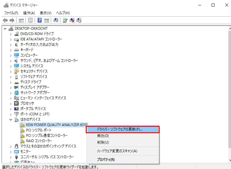
(7) 「コンピューターを参照してドライバーソフトウェアを検索します(R)」を選択して下さい。
