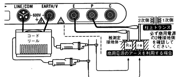
図9 接地抵抗の測定(簡易測定)
