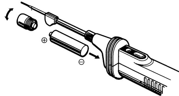
図15 測定プローブの電池交換方法
