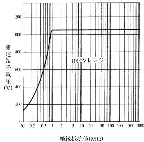
図7 測定端子電圧特性
