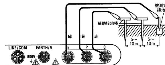
図8 接地抵抗の測定 (精密測定)
