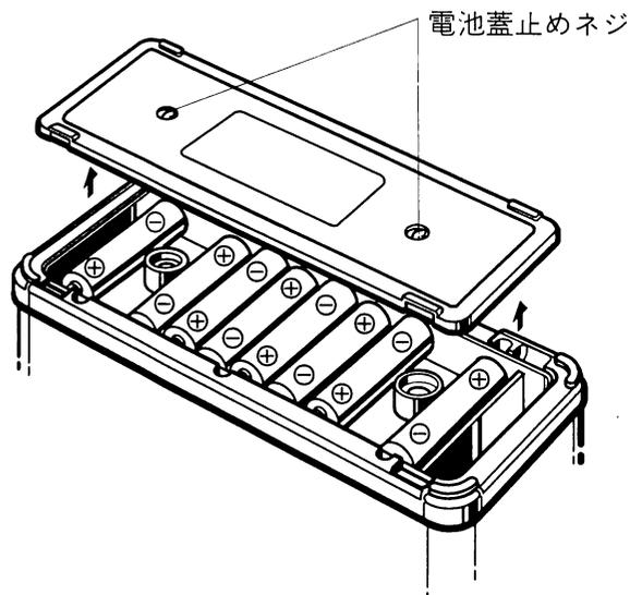
図14 電池の交換方法
