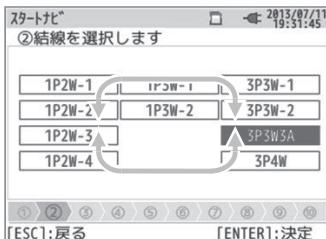
選択項目が縦横に表示してある画面では上下左右のカーソルキーで項目の移動が可能です。結線を選択する左の画面では、上下左右のカーソルキーで測定対象の結線を選択し、ENTERキーで決定します。選択に関係なく前画面に戻るにはESCキーを押してください。
