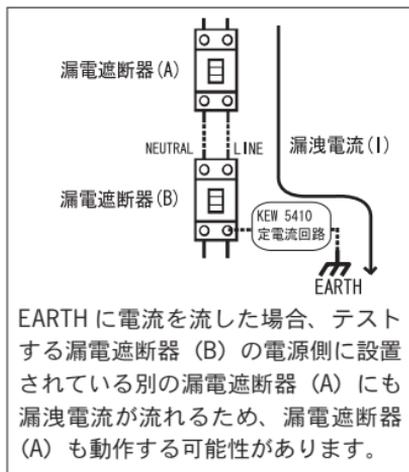
EARTHに電流を流した場合、テストする漏電遮断器 (B) の電源側に設置されている別の漏電遮断器 (A) にも漏洩電流が流れるため、漏電遮断器 (A) も動作する可能性があります。
