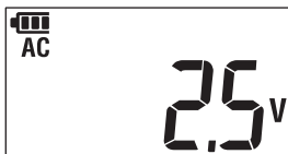
地電圧表示例
