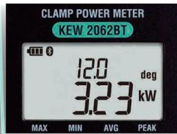
有効電力、無効電力、皮相電力、力率、位相差(1P2Wのみ)など、電力測定に必要な様々なパラメータの測定が可能です。
