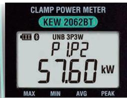
単相2線、単相3線、平衡、不平衡の三相3線、三相4線を簡単に測定できるため、幅広い現場でご使用いただけます。
