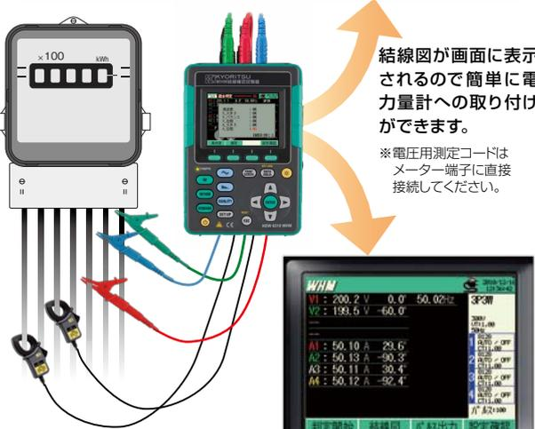
結線図が画面に表示されるので簡単に電力量計への取り付けができます。
