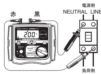
注:本器では、反限時形漏電遮断器において、試験電流:[定格感度電流の2倍]の測定ができません。(JIS C 8221)
