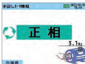
通常の活線状態での検相機能に加え、モータを手で回すことで発生する電圧によって判定が可能です。起動力が低い電圧（0.1～2V）、低い周波数（1～10Hz）での測定ができるため、三相モータの軸を手で回すだけでモータが正しく接続されているか確認できます。
