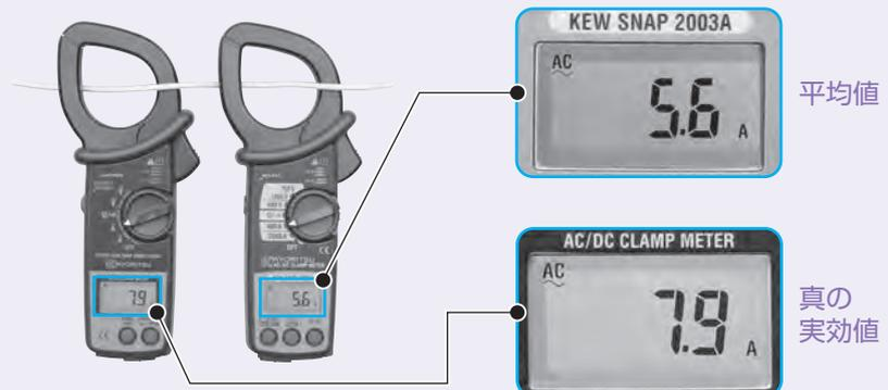
上記はサイリスタ制御のモータ負荷を測定したものです。真の実効値形測定器は7.9Aを指示するのに対して、平均値形測定器は5.6Aを指示します。
