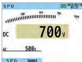
SPD（サージ保護デバイス）が仕様通りの電圧で動作するか確認ができます。最大1000Vまで徐々に電圧を上昇させ、SPD動作時の電圧を測定結果として表示します。
