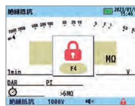
レンジごとにセーフティロックの設定ができるため、測定ボタンを押しても電圧が印加されず誤印可を防ぐことができます。
