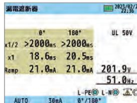
定格感度電流（15～500mA）のあらゆる漏電遮断器試験が可能です。また、動作時間だけでなく、感度電流の確認も可能です。
