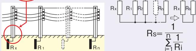
注入トランス(CT1)より被測定物(抵抗Rx)に電圧Vを印加して、その接地抵抗に応じた電流Iを流します。その電流Iを検出トランス(CT2)で検出し、計算により被測定物(抵抗Rx)を求めることができます。
