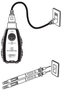
200V用コンセントの場合はプローブピン付コードセットを使用
