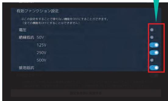
※電圧機能をOFFにしても絶縁・接地抵抗機能の待機状態では電圧値を測定できます。
