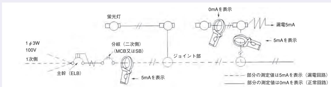
ブレーカの二次側(零相測定)もしくは、アース線(線電流測定)にて、回路の漏れ電流の有無の確認をしてください。漏電している場合には、零相測定にて、クランプ式漏れ電流計の表示値が、5mAを示している回路を順に追っていけば、容易に漏電箇所を捜すことができます。
