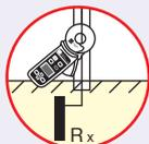
仮に、測定対象の接地抵抗をRx、他の接地の接地抵抗をR1,R2...Rnとします。これらは並列に接続された合成抵抗Rsとし、RsはRxに対し測定に影響の無い抵抗と考えることができます。
