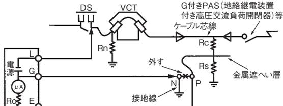
[注] E端子接地方式では、P-N間を短絡し、かつ、G-N間を開放する。
