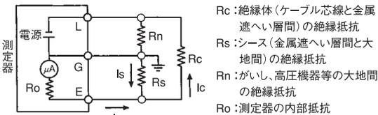
〈第2図〉は、G端子接地方式の等価回路であるが、次式により高圧ケーブル絶縁体の絶縁抵抗を求めることができる。
